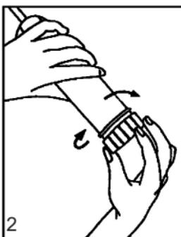
Встановіть насадку або диск потрібної форми в основу циліндричного корпусу і щільно закрутіть.
