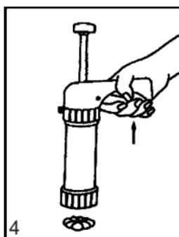
4 Удерживая шприц вертикально, нажмите на ручку спускового механизма и выдавите немного теста перед началом работы.
