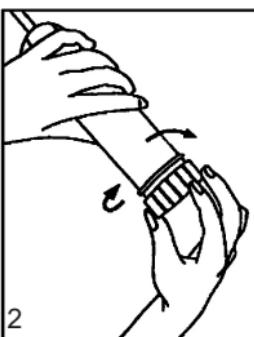
2 Установите узорчатую насадку либо диск нужной формы в основание цилиндрического корпуса и плотно закрутите.
