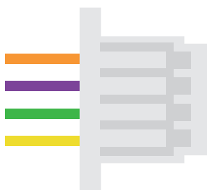
4-х жильный JST кабель
